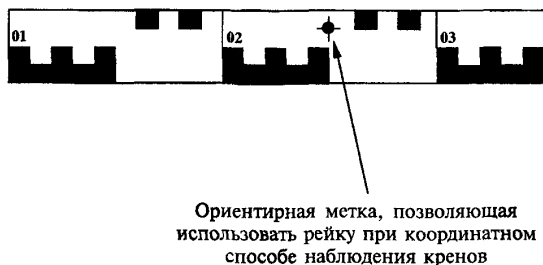
Рисунок 2.2. Специальная рейка для наклонного проектирования теодолитом или электронным тахеометром
